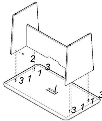
3) Установить стол и вставить кабель канал (5). При необходимости отрегулировать положение стола опорами.
