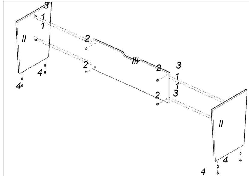
2) Стол рекомендуется собирать на столешнице. Положить столешницу отверстиями вверх. Забить в столешницу шканты (1) и вбить футорки (6) и дюбеля стяжек-эксцентриков (3). Соединить каркас со столешницей и затянуть отверткой стяжки-эксцентрики (2) на боковинах. Закрывать торцы стяжек-эксцентриков декоративными заглушками.
